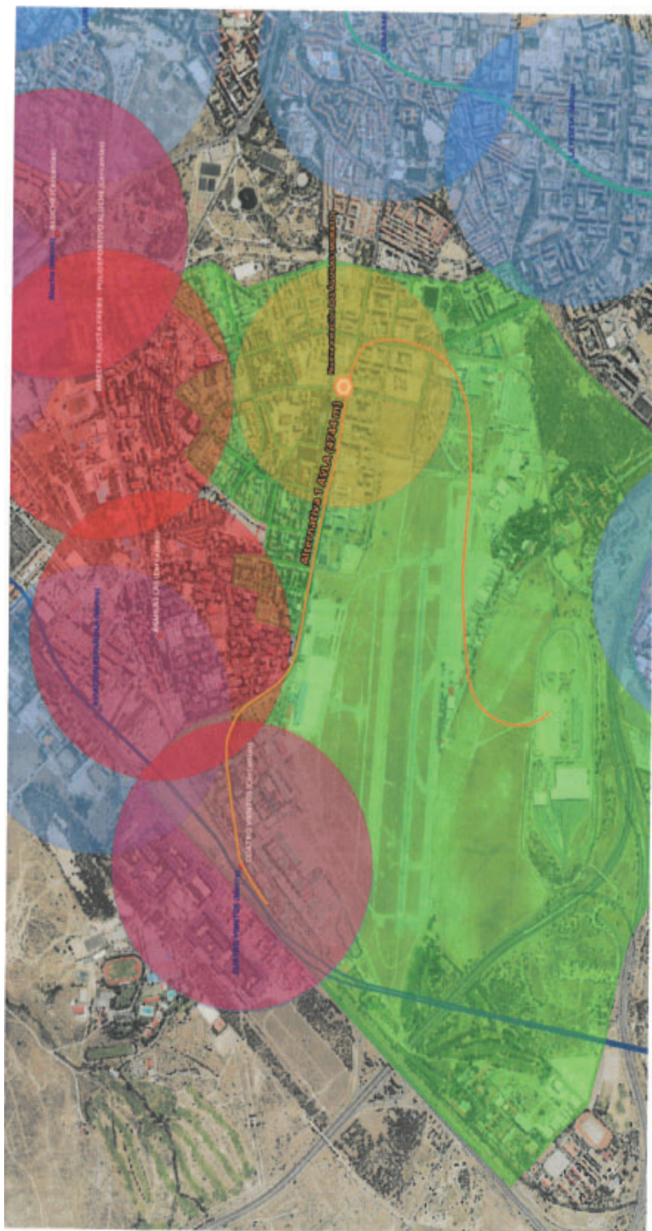
Figura 2. Alternativa 1. Trazado resaltado en naranja desde el fondo de saco del final de la Línea 11 hasta la estación de Cuatro Vientos (Línea 10 y Cercanías). La alternativa contempla la implantación de una nueva estación situada aproximadamente en la intersección entre la Avenida de la Aviación y la Calle José de Cadalso. Se representa la delimitación del área de cobertura peatonal asociada a dicha estación, calculada mediante un radio de 600 metros. Fuente: elaboración propia.
