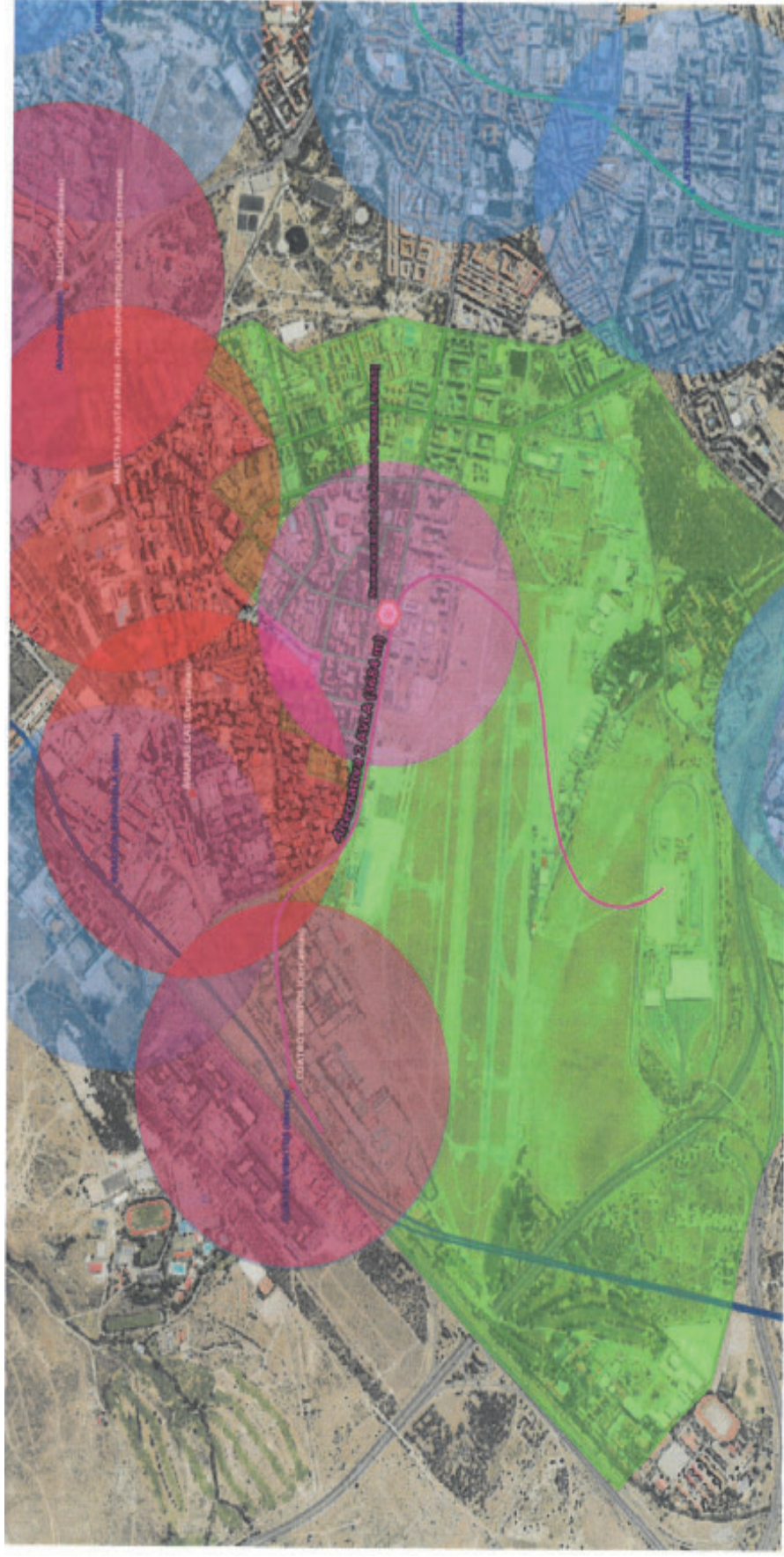
Figura 3. Alternativa 2. Representación del trazado propuesto desde el fondo de saco del final de la Línea 11 hasta la estación de Cuatro Vientos (Línea 10 y Cercanías), resaltado en color rosa. La alternativa contempla la implantación de una nueva estación en las proximidades de la intersección entre la Avenida de la Aviación y la Calle Rafael Fint. Se representa la delimitación del área de cobertura peatonal asociada a dicha estación, calculada mediante un radio de 600 metros. Fuente: elaboración propia.
